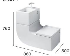
Une solution exclusive de Roca qui associe un lavabo et une cuvette de W.C. dans un seul élément. Non seulement ce modèle permet d'économiser de l'espace, mais il est en outre écologique, car il filtre l'eau du lavabo pour la réutiliser dans la cuvette.
