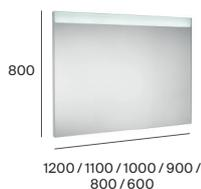
Avec éclairage supérieur et inférieur activable par capteur et plaque anti-buée
